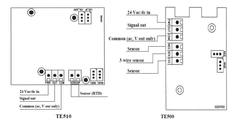
在 4~20mA 输出时,仅用 PWR 和 OUT 两个端子;在 24VAC 供电或电压信号输出时,才会用到 COM 端。 TE510 系列温度变送器可以把探针拆卸下来安装,外壳可远置安装在易于观察的位置。在导线需要加长时, 为了得到精确的测量结果,最好将导线焊接连接。不要使用螺母连接。
